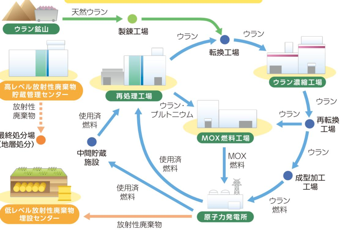
原子力発電所で使い終わつた燃料(使用済燃料)には、まだ使える資源が9割以上残っています。当社は、これらを安全に取り出して加工し、もう一度原子力発電の燃料として使うことができるようリサイクルする「原子燃料サイクル」事業に取り組んでいます。
